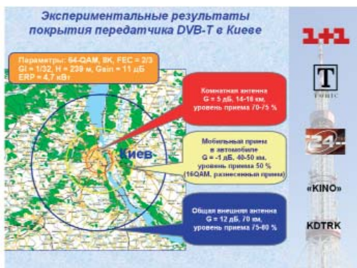
Рис. 15. Экспериментальные результаты покрытия передатчика DVB-T в Киеве
